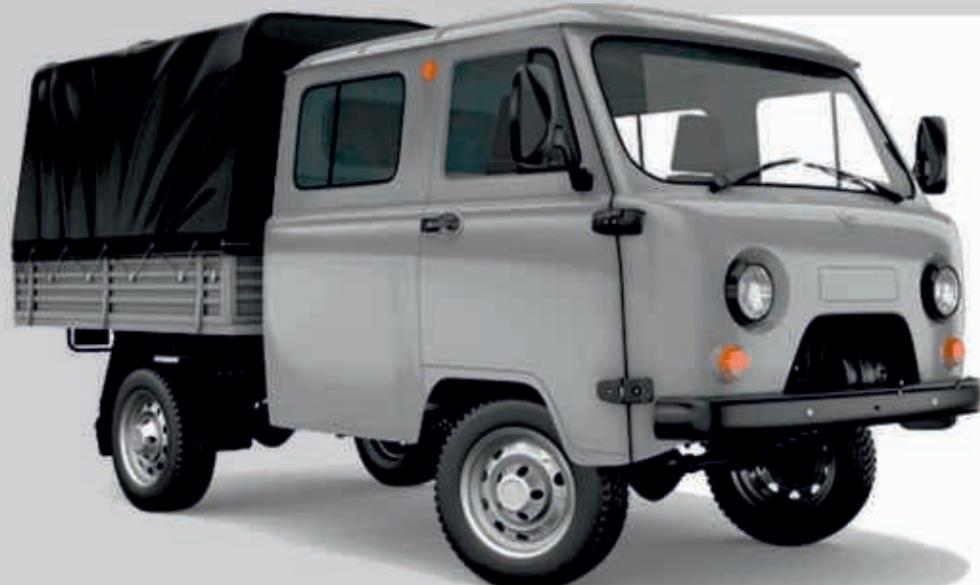
Бортовой грузовик с двойной кабиной УАЗ-39094 «Фермер» оснащается бензиновым мотором ЗМЗ-40911.10 объёмом 2,7 литра и мощностью 112 л. с. в сочетании с пятиступенчатой механической коробкой передач. Автомобиль имеет подключаемый полный привод с понижающей передачей.
