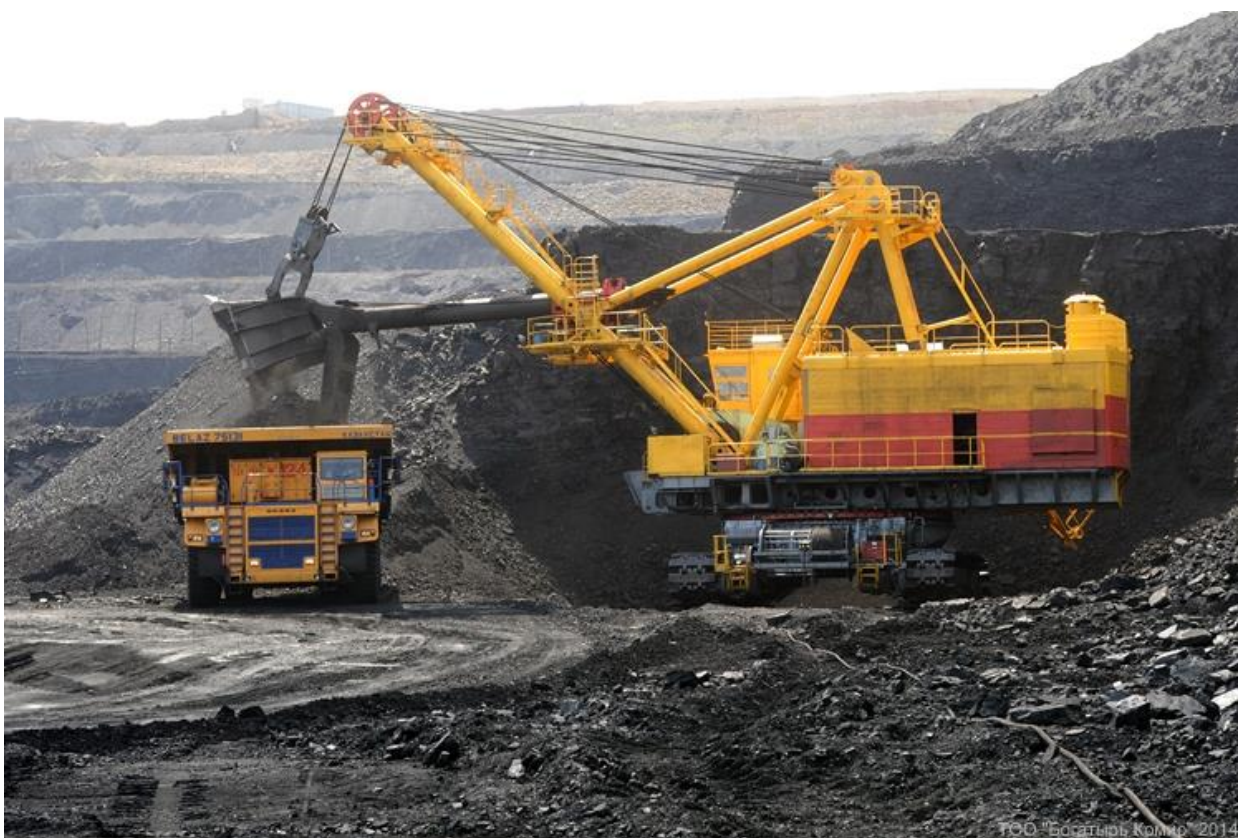
4. Көмірді самосвалдарға арту. Погрузка угля в самосвал.
