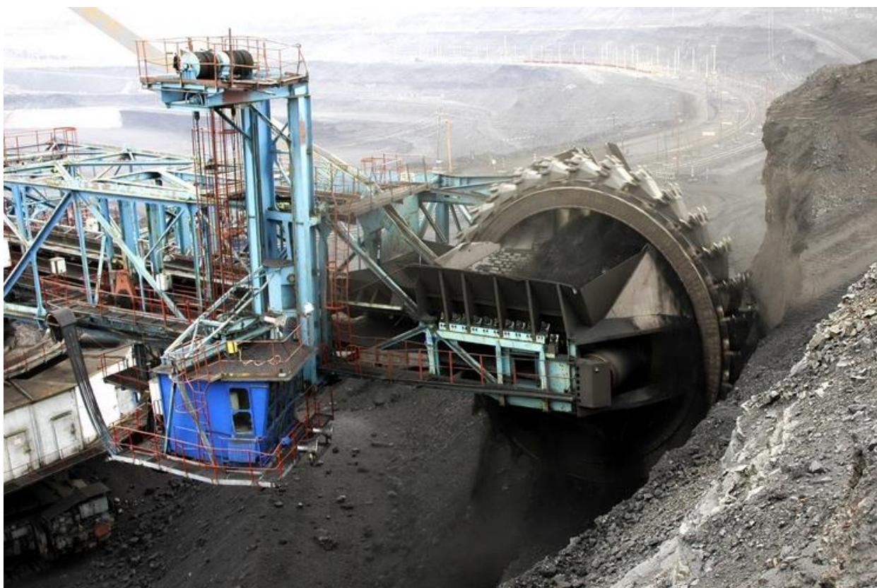
Роторлы экскаватор жұмысы Работа роторного экскаватора
