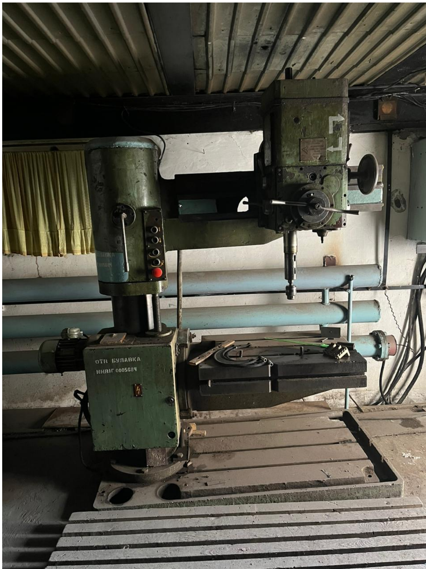
6. Станок радиально-сверлильный 2Л-53 № 1035
